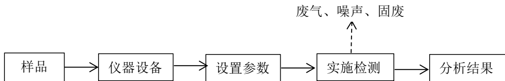
图 2-2 项目物理实验工艺流程及产排污节点图
